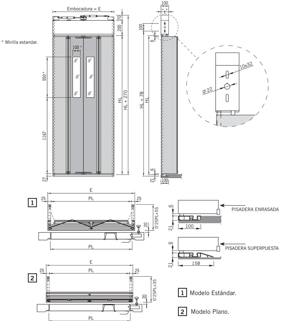
Taladrar dos agujeros (10'25mm.) en las jambas de la embocadura y fijar, mediante 4 tornillos, el operador a las jambas, utilizando los colisos de las cartelas laterales del operador.
