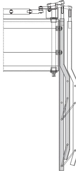
**SISTEMA DE APERTURA MEDIANTE LEVA RETRÁCTIL FRONTAL**
